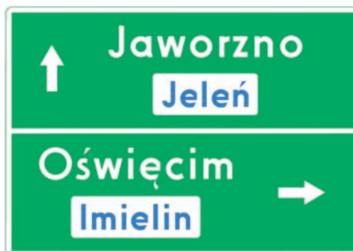
Rys. 6.3.2.7. Drogowskaz E-2a zawierający informację lokalną
