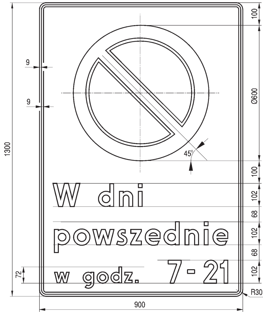
Rys. 9.2.47. Konstrukcja znaku B-39
