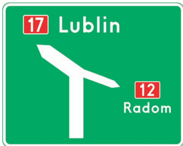
Rys. 6.3.1.3. Tablica E-1 przed trziamiennym skrzyżowaniem dróg krajowych
