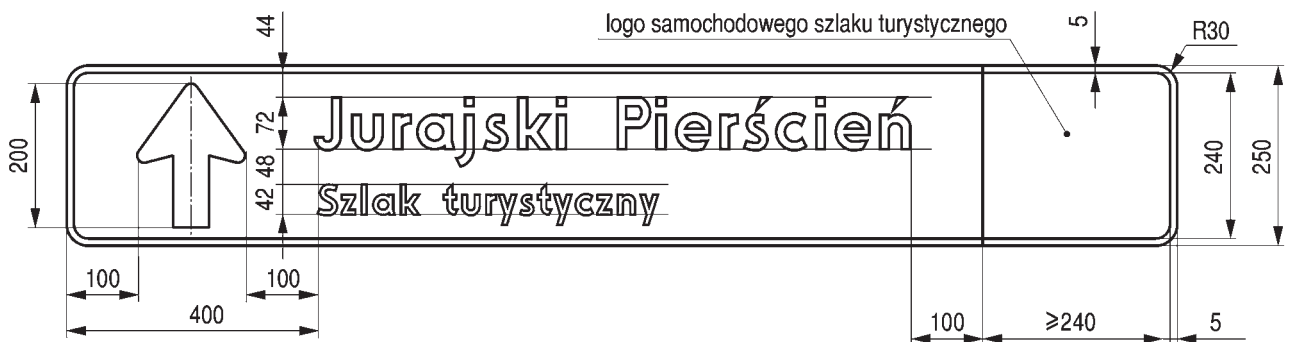
Rys. 9.5.54. Konstrukcja znaku E-22a
