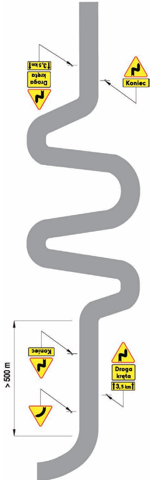
Rys. 2.2.3.4. Oznakowanie drogi z niebezpiecznymi zakrętami
