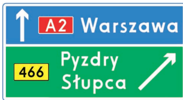
Rys. 6.3.2.5. Drogowskaz E-2c na autostradzie
