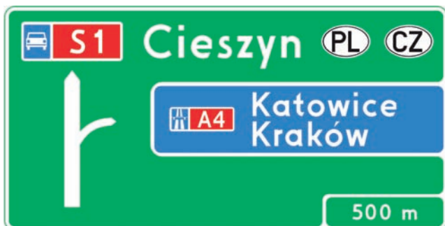
Rys. 6.3.1.11. Tablica E-1b przed węzłem, na którym rozpoczyna się droga ekspresowa i następuje wjazd na autostradę
