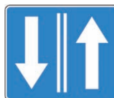
Rys. 7.2.15.2. Znak F-15 dla jezdni dwupasowej dwukierunkowej
