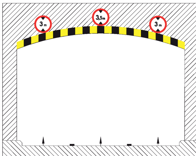
Rys. 3.2.17.2. Zastosowanie znaku B-16 na łukowym sklepieniu tunelu
