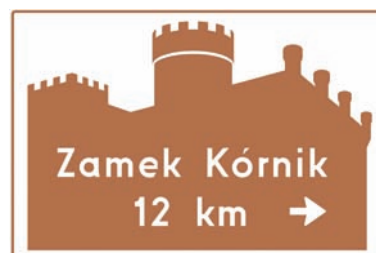
Rys. 6.3.13.3. Znak E-22b wskazujący szczególną atrakcję turystyczną
